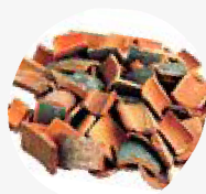
pottuczone cegły i dachówki
